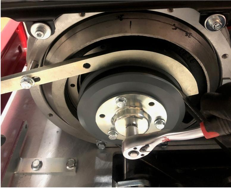
1. Bringen Sie den Hakenschlüssel am Motor an, indem Sie zwischen Motor und Hakenschlüssel die Distanzhülse verwenden.
