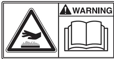
Motor, Schalldämpfer: Um Verbrennungen oder Hitzeinwirkungen zu vermeiden, berühren Sie keine heißen Motorteile, wenn die Maschine läuft oder kurz nachdem die Maschine verwendet wurde.
